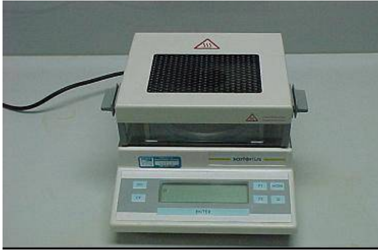
Figure 5.5 Sartorius MA 30 Moisture analyser
