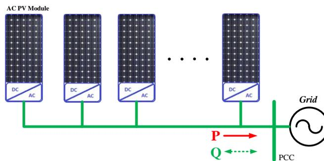
Fig. 1. AC PV Module system.
