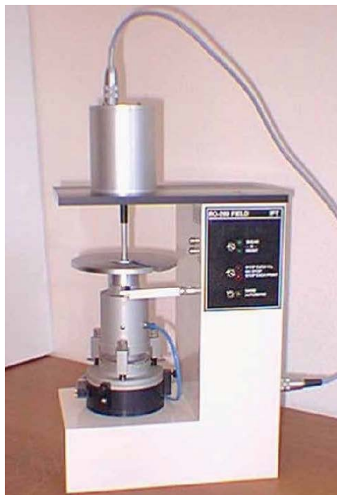
Fig 3 Peschl Shear Tester
