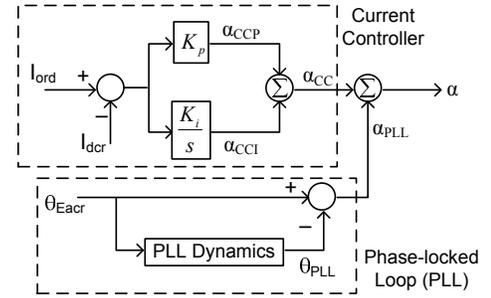
Fig. 3. Converter Control
