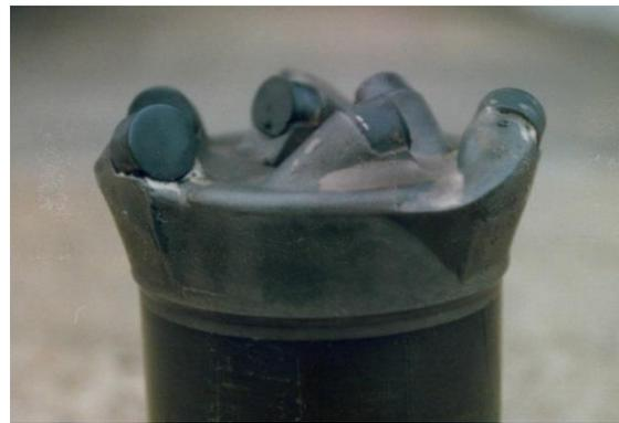
**Figure 17 - Modified Longyear 89 mm DHM PCD bit**
