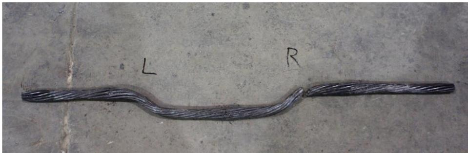
Fig. 6. Failure angle of cable bolt.
