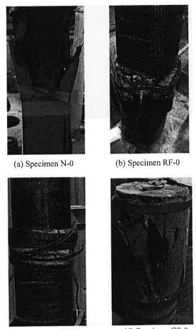
(c) Specimen CF-0 (d) Specimen CS-0 Figure 6. Failure modes of concentrically loaded columns
