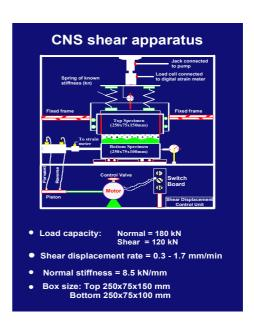
Fig. 3. CNS apparatus
